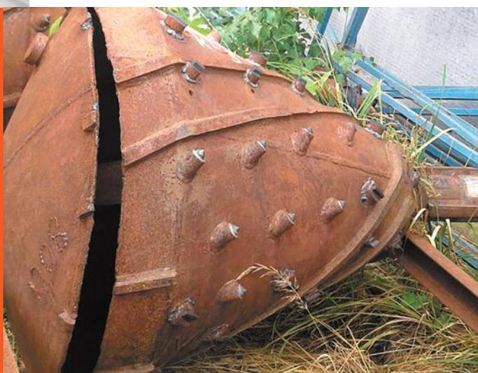
Не секрет, что в России многие производят буровой инструмент для машин горизонтально-направленного бурения, в основном его делают в гаражных кооперативах. Люди, которые знают как он должен выглядеть, но плохо знакомы с технологией, у которых из оснащения есть токарный, фрезерный и сварочные станки.
